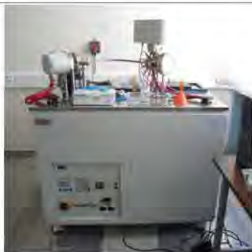
Vue du spectromètre Thermofischer Argus
